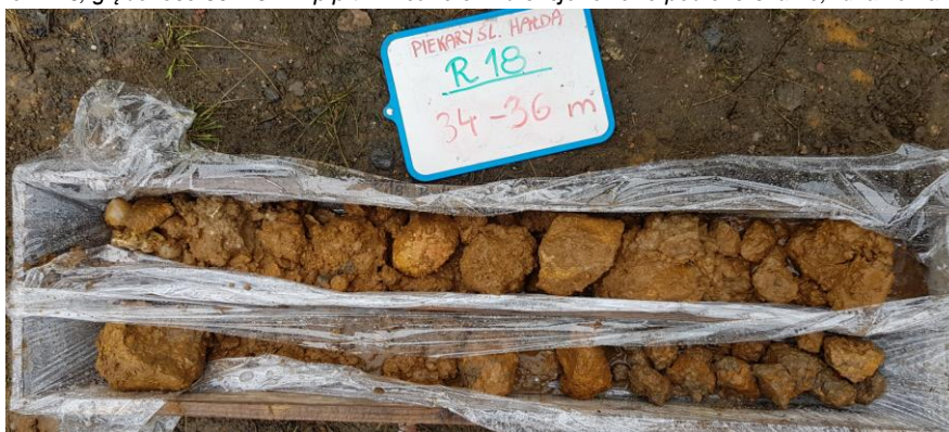
Fot.6. Otwór R18, głębokość 34 – 36 m p.p.t. zwietrzałe i zbrektonowane podłoże skalne, rdzawe naloty, ślady przepływu wody
