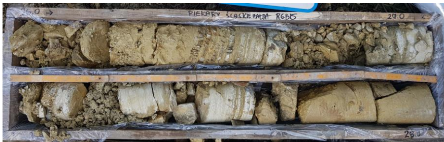
Fot.4. Otwór R6bis, głębokość 20 – 22 m p.p.t. zwietrzałe i zbrektonowane podłoże skalne, wtórne wypełnienia
