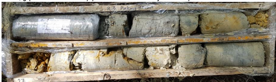
Fot. 2. Otwór R3, głębokość 26 – 28 m p.p.t. rdzawe naloty w spękaniach, ślady przepływu wody
